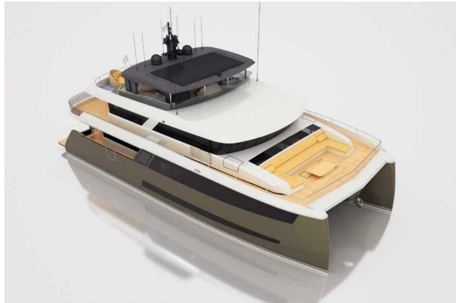
In der Animation macht der Doppelrumpf einen modernen, schnittigen Eindruck. Bestückt mit zwei MTU 10 V 2000 M 96-Motoren mit jeweils 1.920 PS soll eine maximale Geschwindigkeit von bis zu 18 Knoten (33 km/h) möglich sein. Der Cruising Speed wird mit 11 Knoten (20 km/h) angegeben. Der Kat kann auf Wunsch jedoch auch mit E-Antrieb (Hybrid) geliefert werden.
